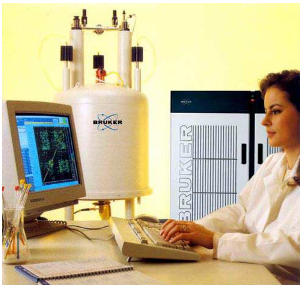
图 4.1 操作控制台、机柜和磁体系统
